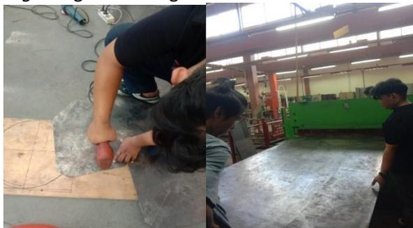
Gambar 8. Proses Pemotongan Plat
