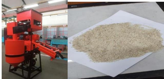
Gambar 22. Hasil Mesin Penggiling padi (*rice milling*)
