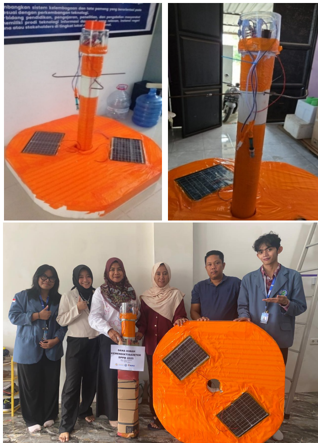
Gambar 4. Prototipe Smart Aquaculture dengan Panel Surya dan Sensor IoT
